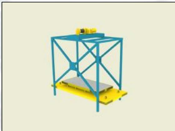
помощью гидротолкателем. При посадке в ярус выдвижной упор опирается на регулируемый по высоте жесткий упор.
